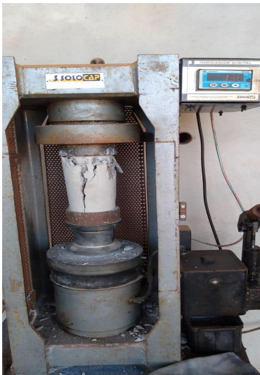
Figura 2 - Rompimento de corpo de prova s14 em prensa hidráulica manual - Fonte: Própria (2019).
