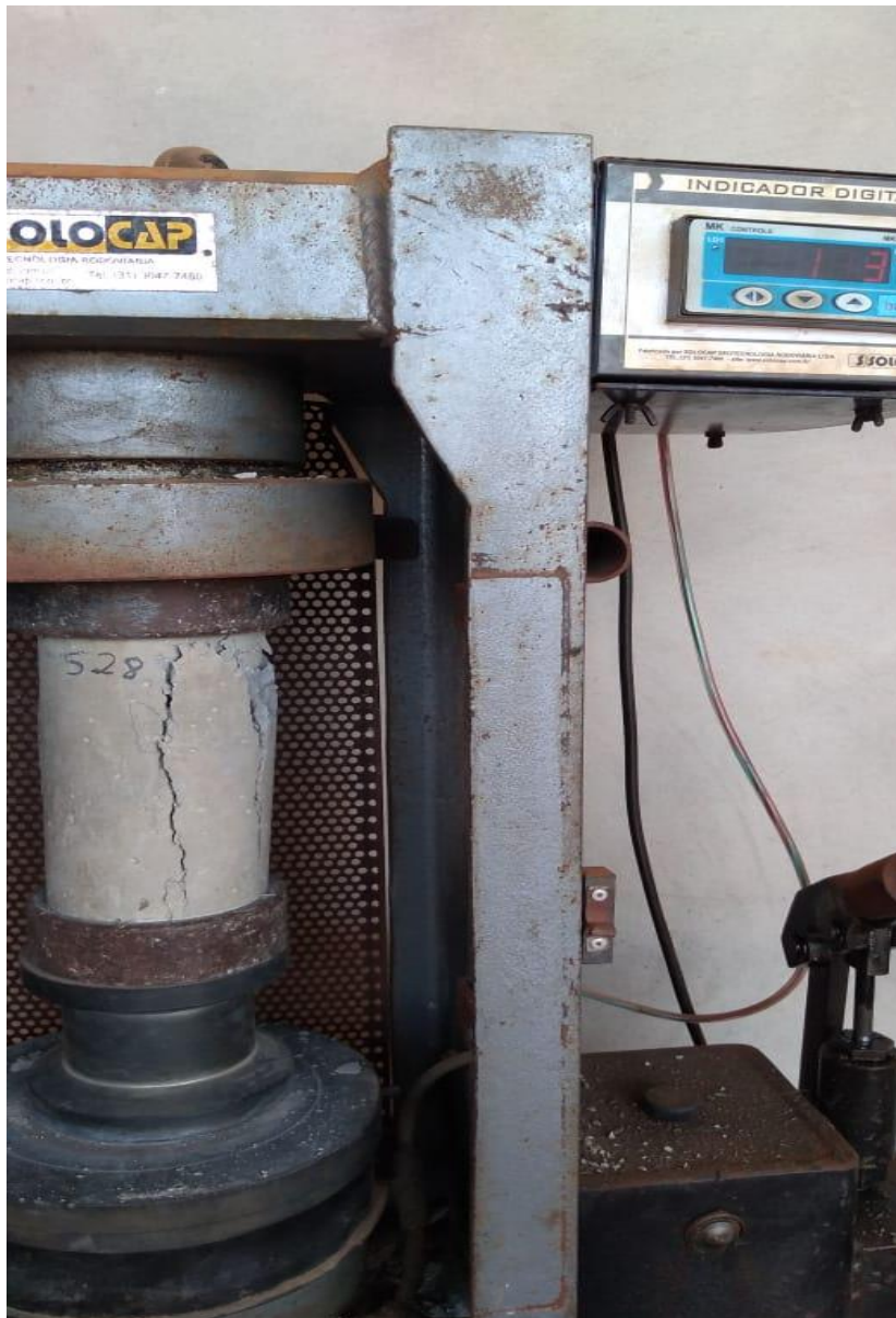
Figura 4 - Rompimento Corpo de Prova S28 em prensa hidráulica - Fonte: Própria (2019).
