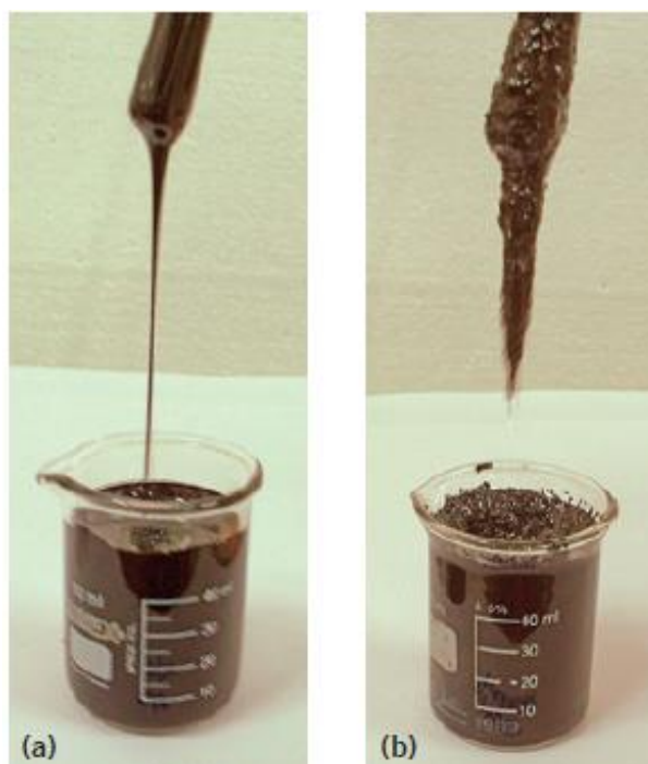
Figura 10 – Comparação entre asfalto convencional (a) e asfalto borracha (b)
